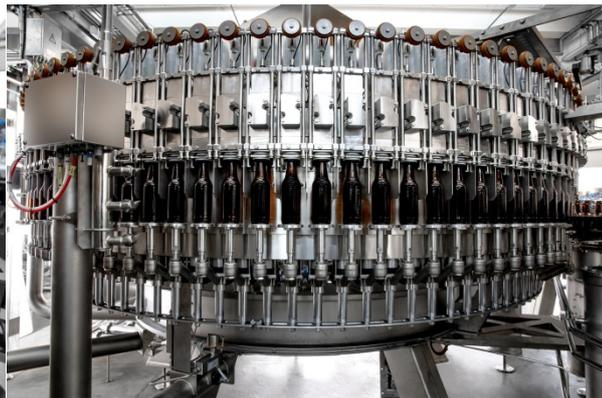
EvoFILL Glass 在工程设计上符合高卫生标准。该设备可确保生产商为消费者提供一流质量的产品，由于采用“无底座”结构，在生产和维护期间非常易于操作。
